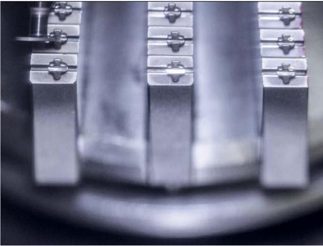
Abb. 33 Präzision der Slotdimension durch Fräsen
