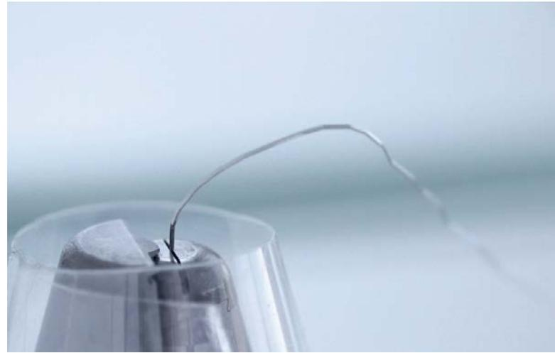
Abb. 34 Herstellung individueller Bögen durch hochpräzisen Biegeroboter
