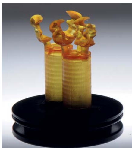
Abb. 21 und 22: 3-D-Druck der Teilkronen mit dem Dekema trixprint 3-D-Drucker
