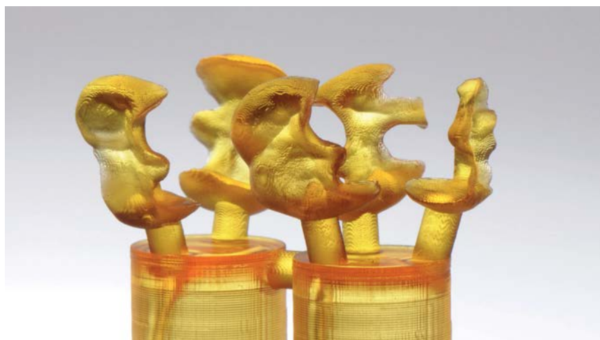
Abb. 21 und 22: 3-D-Druck der Teilkronen mit dem Dekema trixprint 3-D-Drucker
