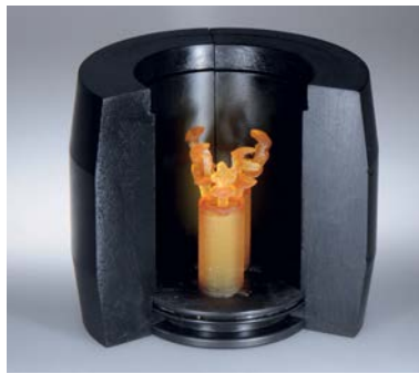
Abb. 23 und 24: Nach dem 3-D-Druckprozess erfolgen das Reinigen und Härten der Bauteile sowie das Einbetten in die trixpress-Muffel.
