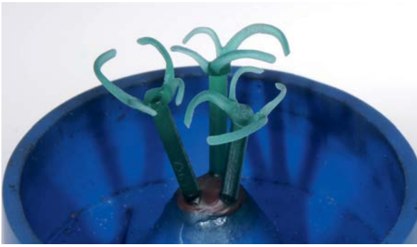
Abb. 7 und 8: Einbetten und Gießen der 3-D-gedruckten Klammern
